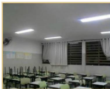
Fig. 3 – Sala com luminárias de TCC 6500 K
