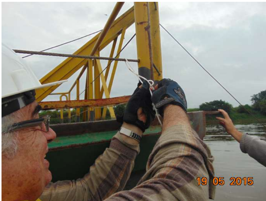
Figura 19. Amarração da corda com as distâncias marcadas para medição da turbidez a jusante da draga (Porto Seguro)
