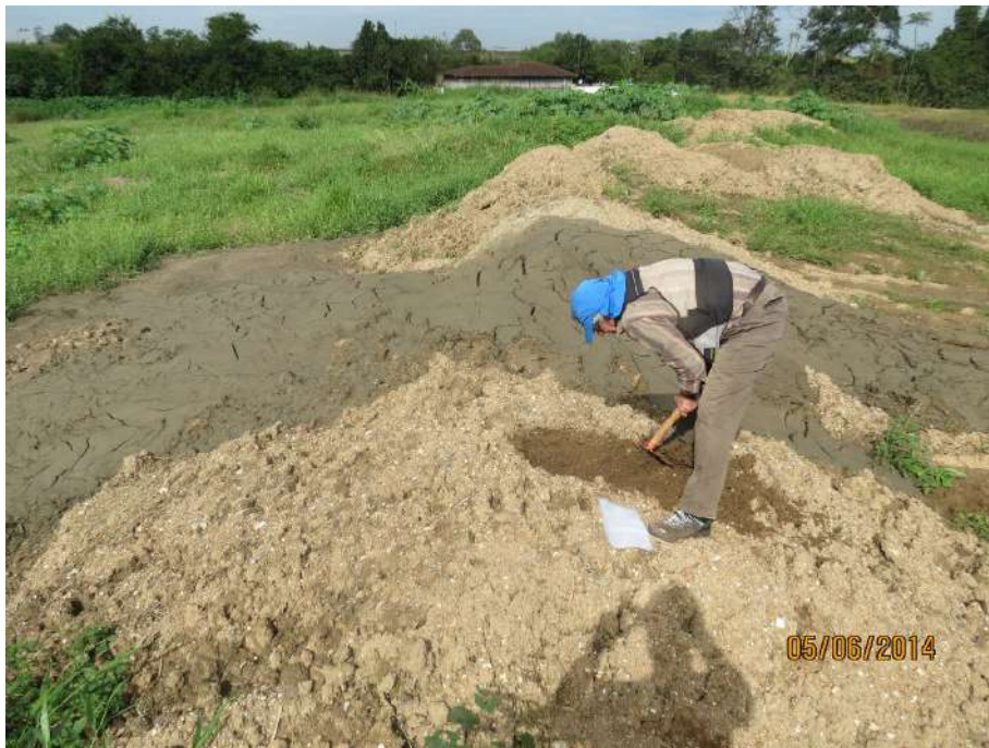
Figura 22 Coleta de amostra de rejeito de areias de descarte da lavagem (Porto Seguro).
