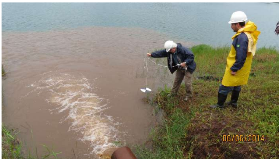
Figura 35 Medição de turbidez no ponto de retorno da água ao rio a partir do decantador (Porto Seguro)
