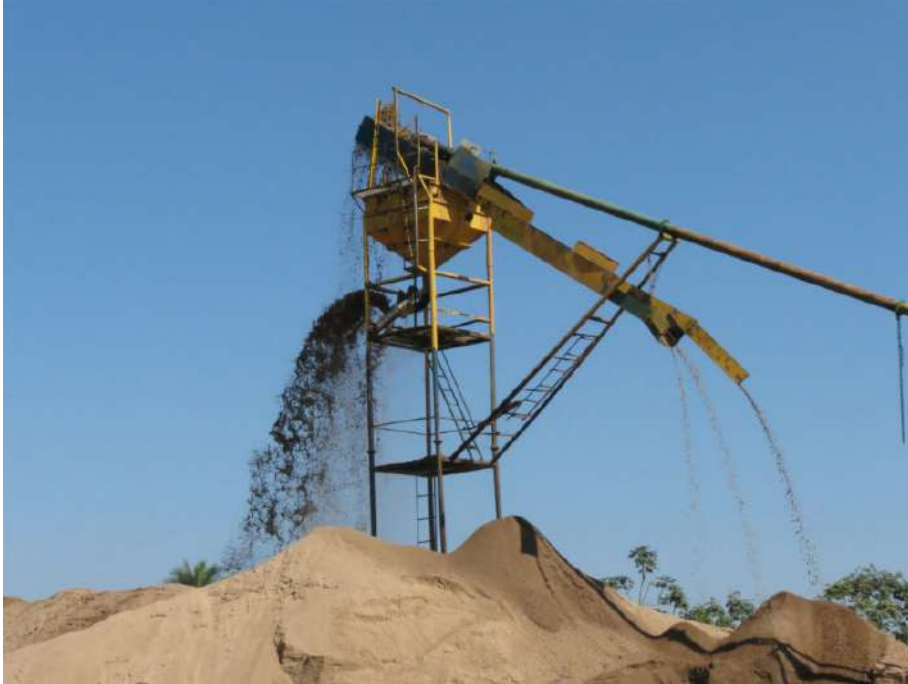
Figura 8. Separação, drenagem e secagem da areia retirada (Porto Pirâmide)
