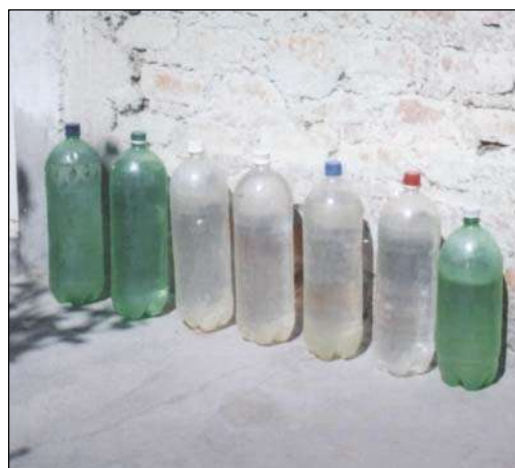
Figura 2.13. Garrafas PET de refrigerante pintadas de preto (esquerda) e outras não (direita), contendo água expostas ao Sol. [Foto: F. Morante, 2004]
