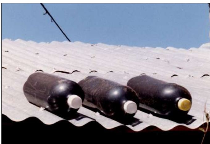
Figura 2.13. Garrafas PET de refrigerante pintadas de preto (esquerda) e outras não (direita), contendo água expostas ao Sol. [Foto: F. Morante, 2004]
