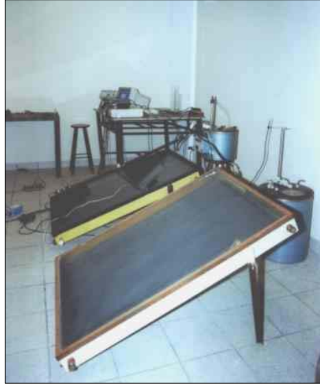
Figura 3.7. Caixa coletora com suportes. [Foto: M. Salcedo, 2003]
