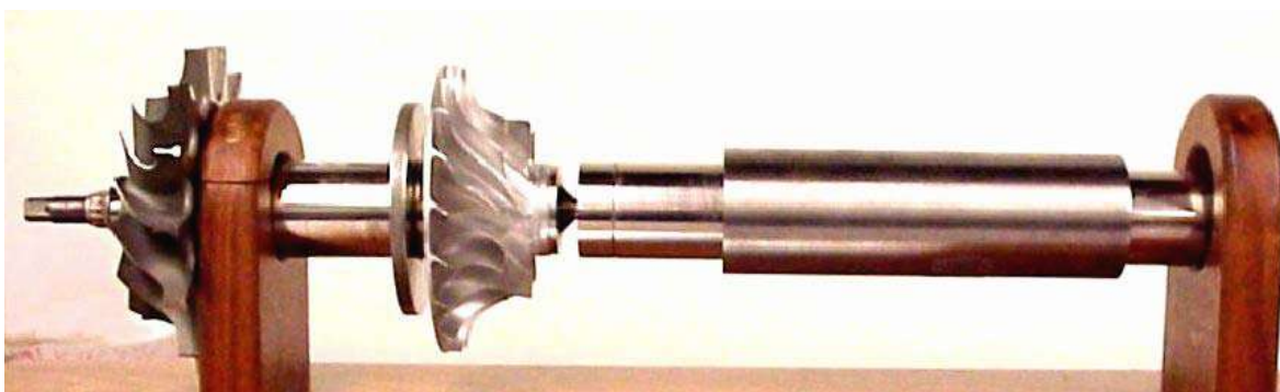
Fig. 2.18 - Detalhe do Eixo Único Compressor/Turbina de Expansão/Gerador com Mancal de Suspensão a Ar da Microturbina Capstone.
