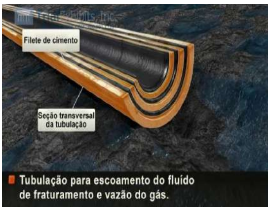
i Tubulação com reforço de camada de concreto para evitar que pequenas rachaduras nas juntas dos tubos possa permitir vazamento de fluido de fraturamento hidráulico ou gás
