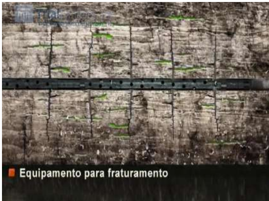
g Detalhe da sonda com furos para permitir num primeiro momento as micro explosões para abertura das fissuras.
