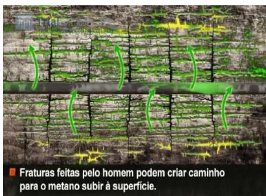
Fig.33v -Fraturas que podem criar caminhos alternativos para o escape de metano
