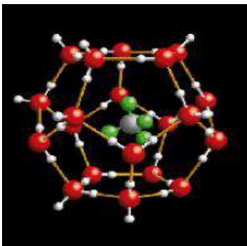
Fig. 12 Estrutura dos Hidratos de Gás – Gaiolas ( cages ) Formadas por Moléculas de Água que “Aprisionam” Moléculas de Gás.( PEER , 2014.)
