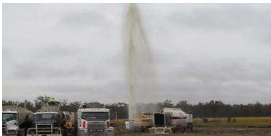
Fig. 34 – Evento de blowout, com projeção de fluidos, em um poço de gás( Action on Coal and Gas,2010)
