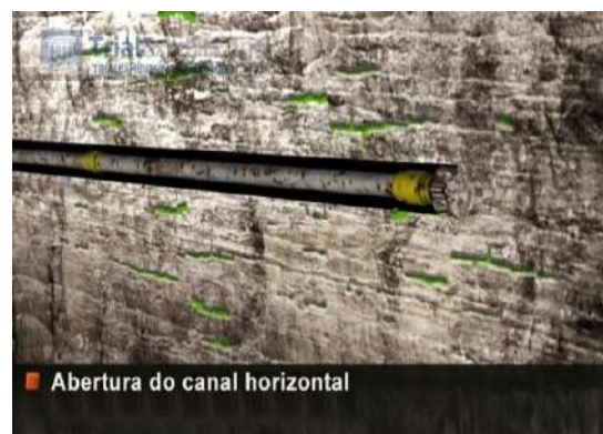
f Detalhe do canal horizontal, em verde os bolsões de shale gas.
