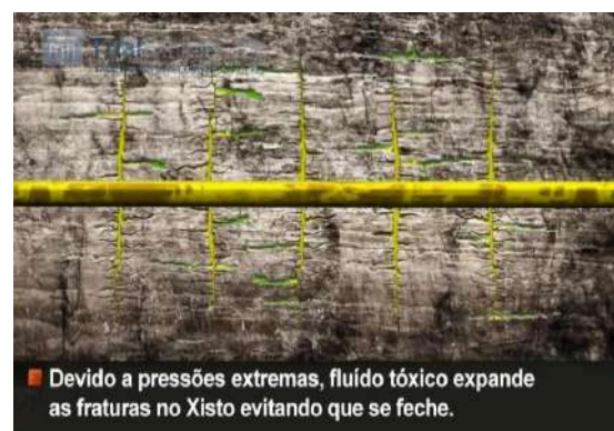
l Fissuras sendo preenchidas pelo fluido de de fraturamento com o material propante evitando que elas se fechem com o tempo
