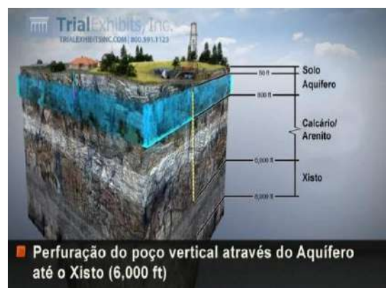
d Início da perfuração através de um poço vertical até atingir a camada do folhelho e instala-se uma tubulação para proteção das várias camadas do subsolo.
