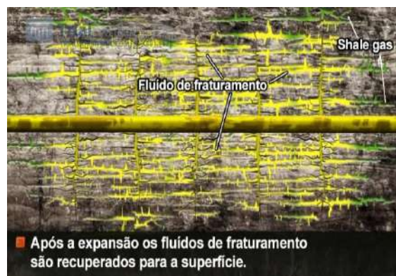
Fig.28 Fraturamento das rochas de folhelho
