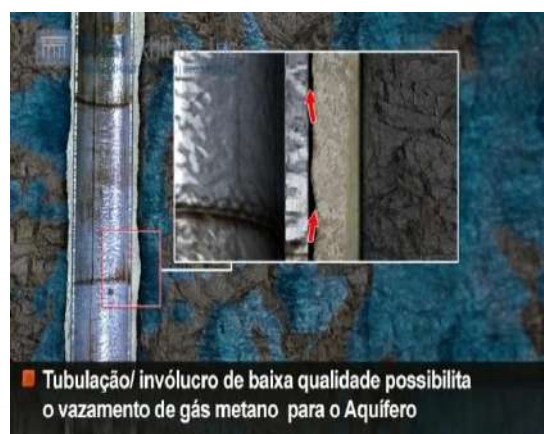
Fig.33t - Possibilidade de vazamento de gás através de soldas e/ou cimentação de baixa.
