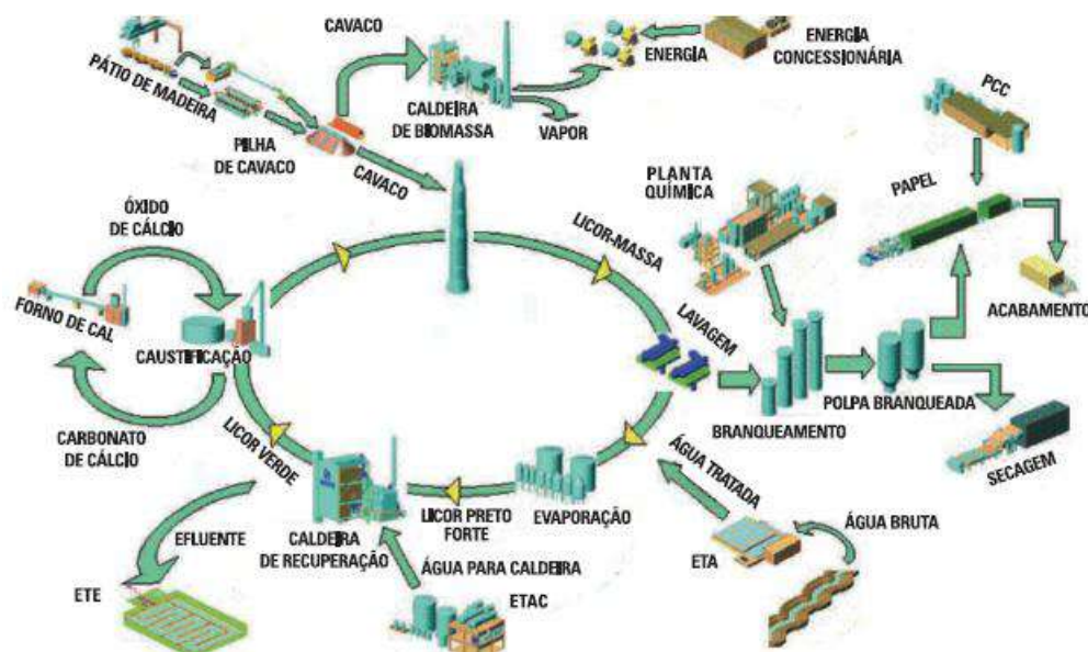
Figura 5. Fluxograma simplificado do processo Kraft de produção de celulose e papel. Fonte: (CETESB; SMA, 2007).
