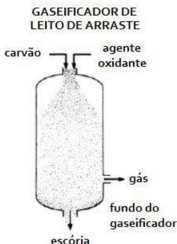
Figura 17. Esquema do gaseificador de fluxo de arraste Fonte: Adaptado de FERREIRA (2008)
