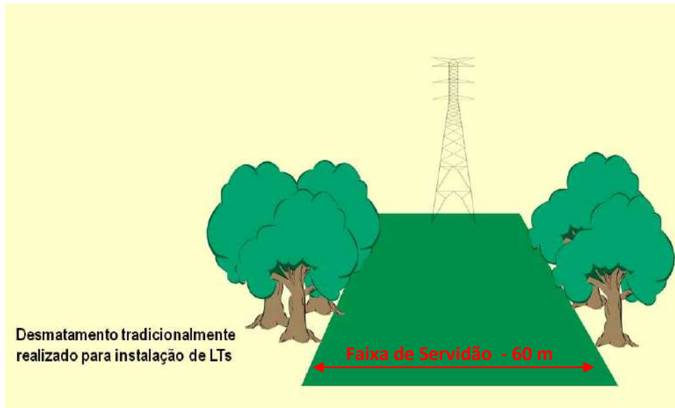
Figura 15 - Ilustrando o modelo tradicional de supressão de vegetação (corte raso) na faixa de servidão.
