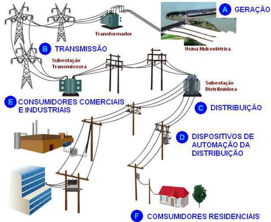
Figura 01 - Ilustração do caminho da energia elétrica
