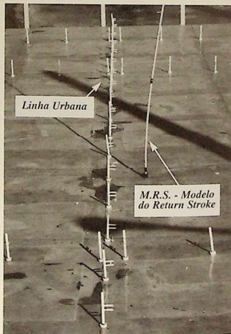
Modelo em escala reduzida para estudo de tensões induzidas em linhas urbanas
