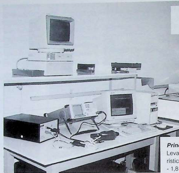
Ensaio de interferência conduzida (150kHz - 30 MHz)
