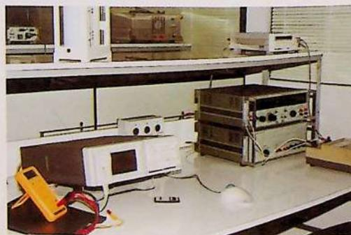
Bancada para Calibração de Voltímetros, Amperímetros e Multímetros.
