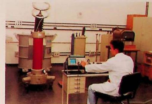
Calibração de Divisor Capacitivo para Alta Tensão CA de 200kV
