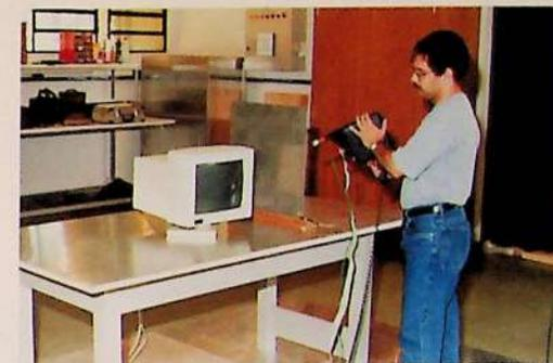
Ensaio de Susceptibilidade a Descargas Eletrostáticas (IEC 1000-4-2)
