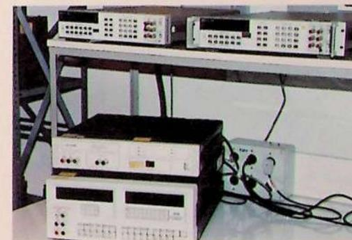
Calibrador de Multimetros Digitais
