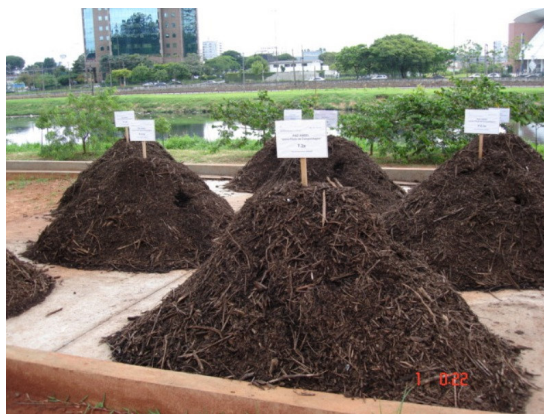
Figura 2. Primeira fase dos experimentos: Fase I - leiras com revolvimento
