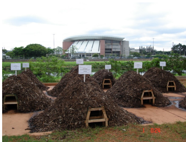
Figura 3. Segunda fase dos experimentos: Fase II - leiras com aeração estática.
