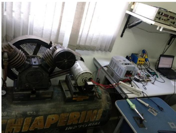
Figura 7 – MRC acoplado a compressor de 20 PCM
