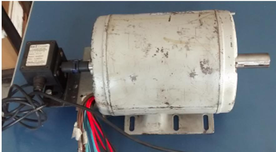
Figura 5 – Protótipo do MRC montado com o sensor de posição
