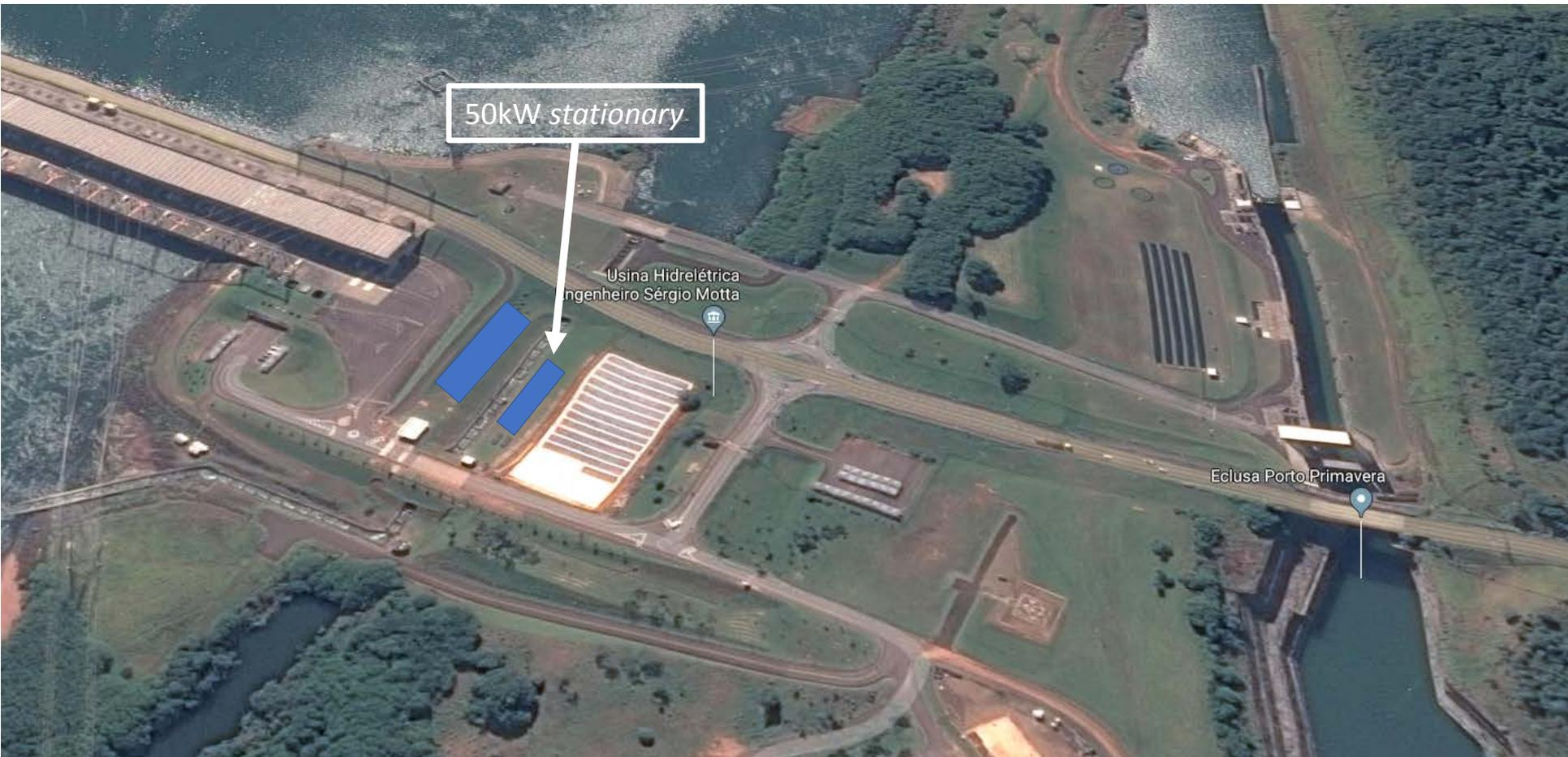
**50kW em painéis rígidos policristalinos instalados.**
