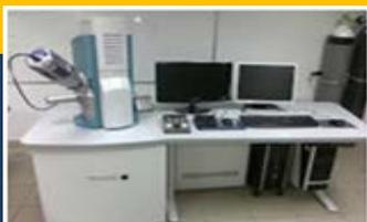
Microscopio Electrónico de Barrido (SEM)
