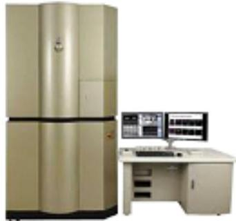
MICROSCOPIO ELECTRÓNICO DE TRANSMISIÓN
