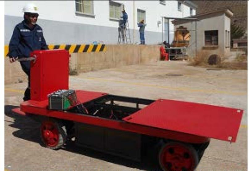
*Transporta carga funcionando con pack de baterías de ion litio*
